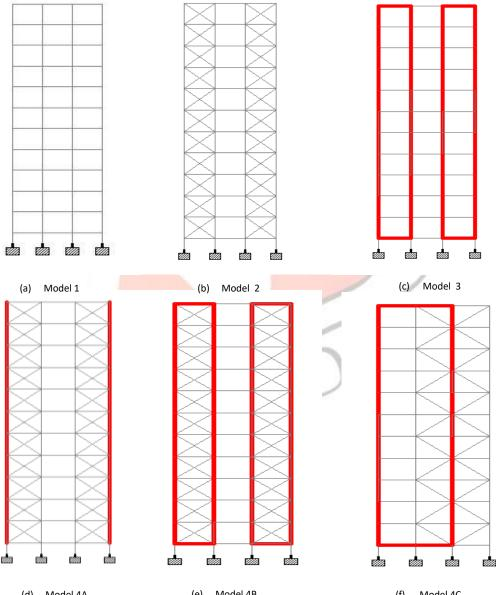
(d) Model 4A (e) Model 4B (f) Model 4C Figure 2 Configurations of Different Models
