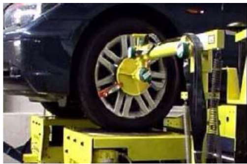
Fig. 11 Suspension parameter measuring machine (SPMM) test rig.
